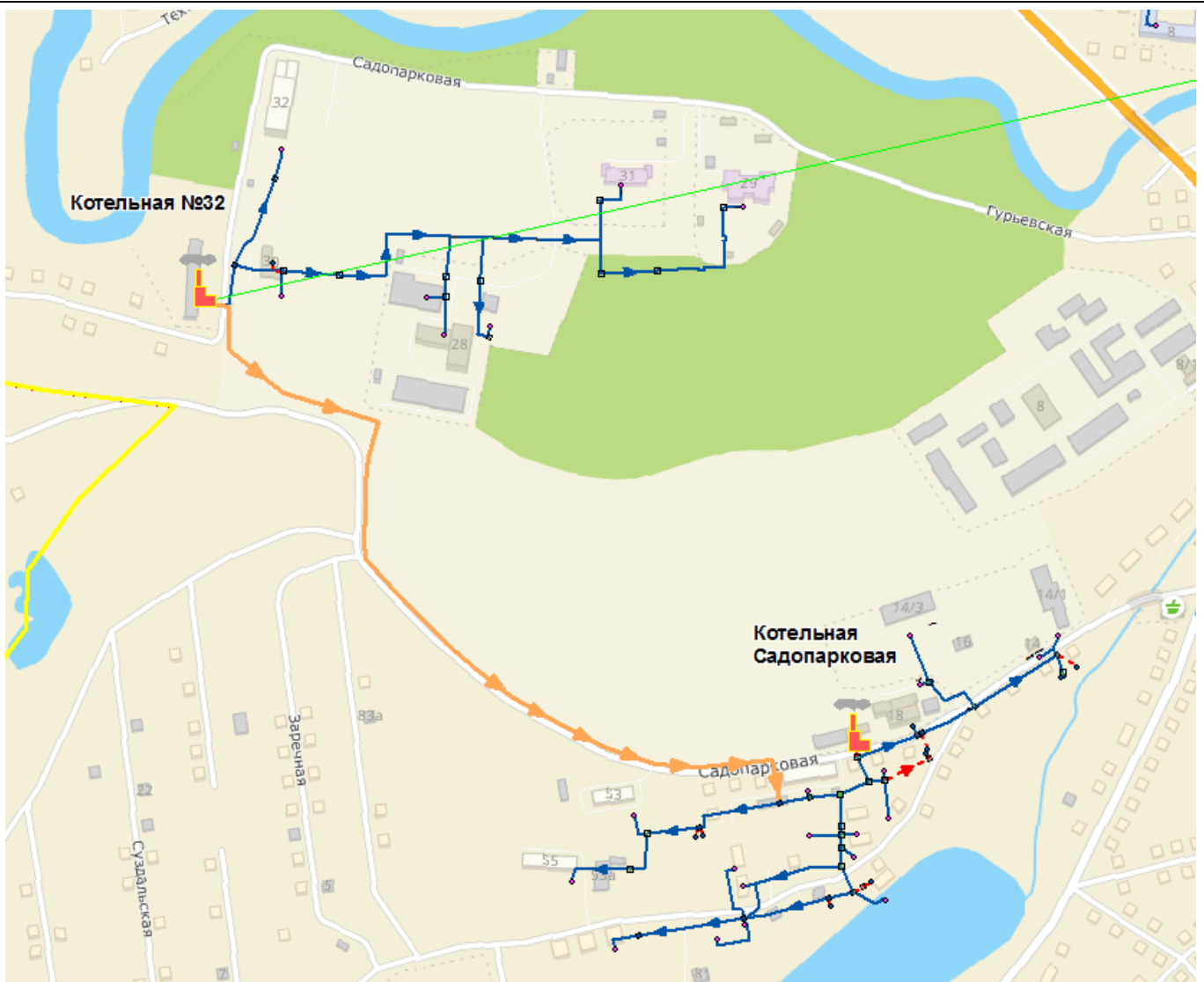
Рисунок 42 – Строительство тепловых сетей для переключения котельной Садопарковая на котельную №32
